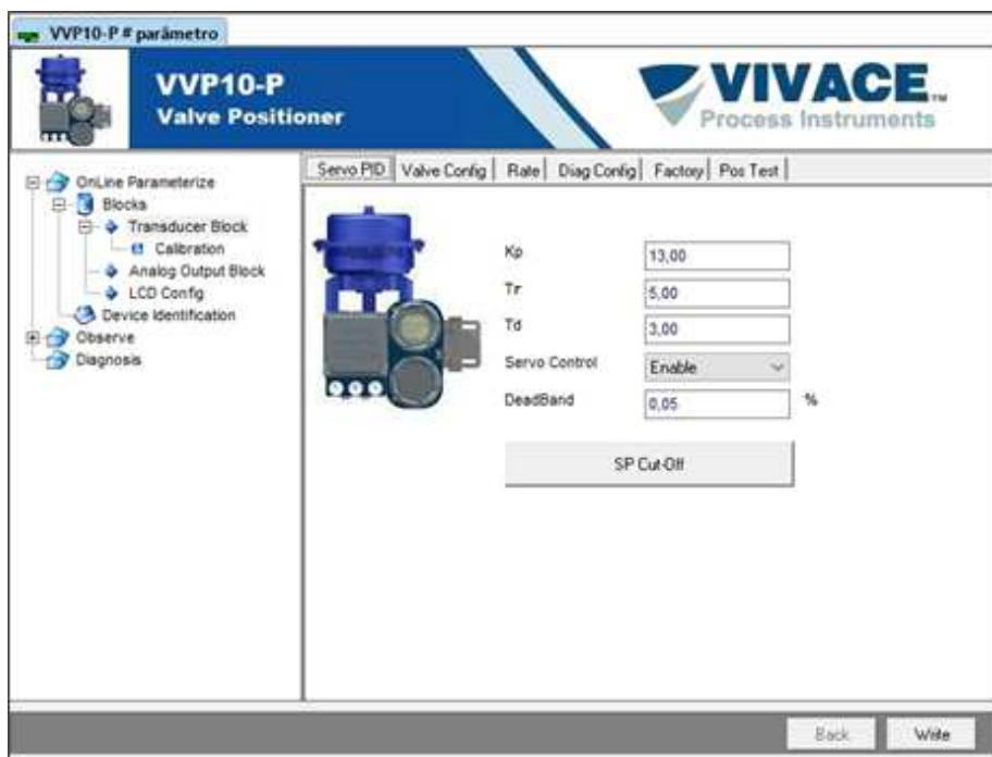
Figura 3.11 – Pantalla de configuración del VVP10-P en PACTware.
