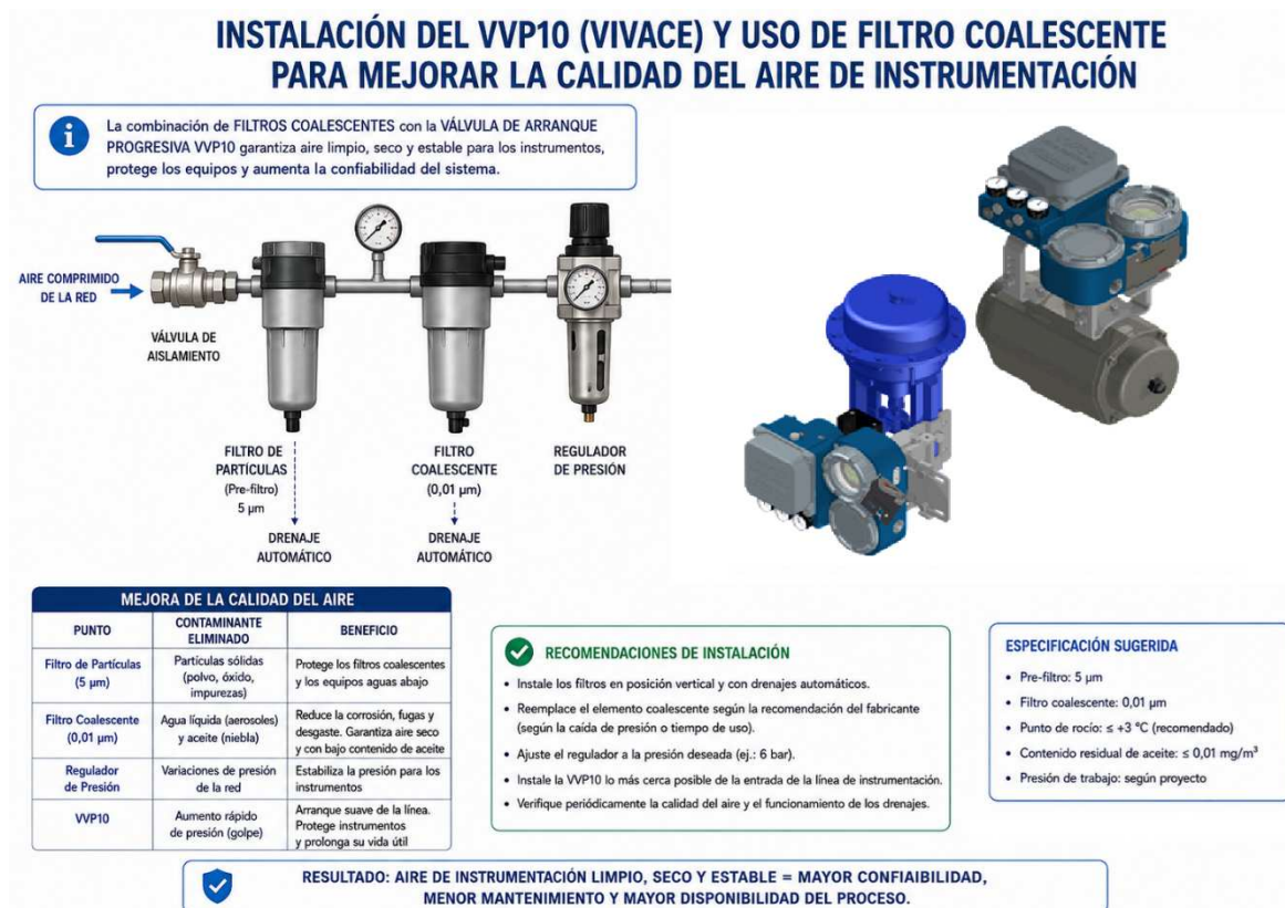
Figura 2.19 – Uso de filtro coalescente para mejorar la calidad del aire de instrumentación.
